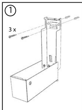
Wandmontage – Beiliegende Dübel und Schrauben verwenden.
