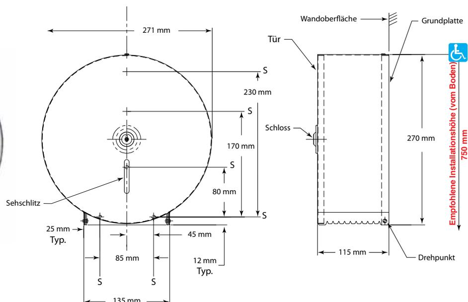
**MATERIAL:****Montageplatte** — Edelstahl, 1,6 mm.**Tür** — Edelstahl X5 CrNi 18/10 (1.4301), 0,8 mm dick, matt geschliffen. Schlitz lässt Toilettenpapier-Füllstand im Gehäuse erkennen. Ausgestattet mit einem Systemschloss für Bobrick-Waschraumausstattungen.**Spindel** — Lässt sich dank abnehmbarer O-Ringe aus Gummi in eine kleinere Spindel umrüsten. Feste innere Spindel, Edelstahl, 0,9 mm.**BEDIENUNG:**
