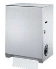
Edelstahl, matt geschliffen. Berührungsloser Zugmechanismus gibt 305 mm lange Papiertücher von universellen Papierrollen ab. Geeignet für Rollen von 203 mm Breite, 244 m Länge und einem Durchmesser von bis zu 203 mm. Automatischer Übergang der Restrolle bis zu 89 mm Durchmesser. Benötigter Kraftaufwand : 8,0 N. Tür mit Zylinderschloss und Stangenscharnier.
