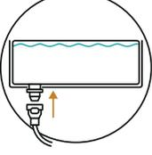
› Verbinden Sie die Zuleitung mit der Kartusche
