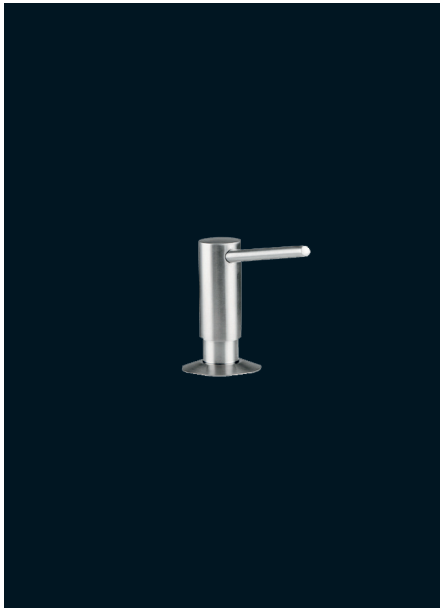
Tisch-Seifenspender klein mit funktionalem Design. In Edelstahl (PU-148-ST) und in verchromter (PU-148-CR) Ausführung. Bewährte Pumpentechnik. Kann zur Reinigung und Befüllung von oben entnommen werden. Fassungsvermögen des Nachfüllbehälters ca. 250 ml. Inkl. Montagezubehör. Countertop soap dispenser. In stainless steel (PU-148-ST) or chrome plated (PU-148-CR) available. Pump can be taken out from the top for cleaning and filling purpose. Contains 0.25 litre bottle and mounting parts.
