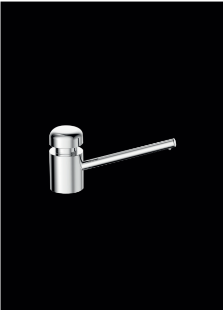
Verchromter Tisch-Seifenspender. Länge Auslauf: 140 mm. Sehr stabile Metallpumpe mit diebstahlsicherer Montage. Kann zur Reinigung und Befüllung von oben entnommen werden. Fassungsvermögen ca. 1 Liter. Inkl. Schlauch mit 1,5 m zur direkten Entnahme aus Seifenkanister. Countertop soap dispenser, chrome plated. Outlet with 140mm length. Very solid vandal protected metal pump. Pumphead can be taken off for cleaning and filling purpose. Contains 1 litre bottle and tube with 1.5 m for soap canister.
