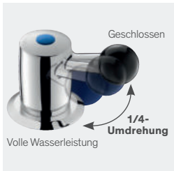
Long-Life-Oberteil mit voller Wasserleistung nach 1/4-Umdrehung
