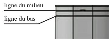
Bien centrer verticalement et horizontalement la boîte de montage grâce au niveau intégré dans le couvercle de celle-ci. Serrer la boîte de montage avec les 4 vis fournies. **Attention:** le sol doit être assez haut pour que le haut de la boîte de montage dépasse et soit entre la ligne du bas et la ligne du milieu avant d'être découpé (voir schéma numéro 4).
